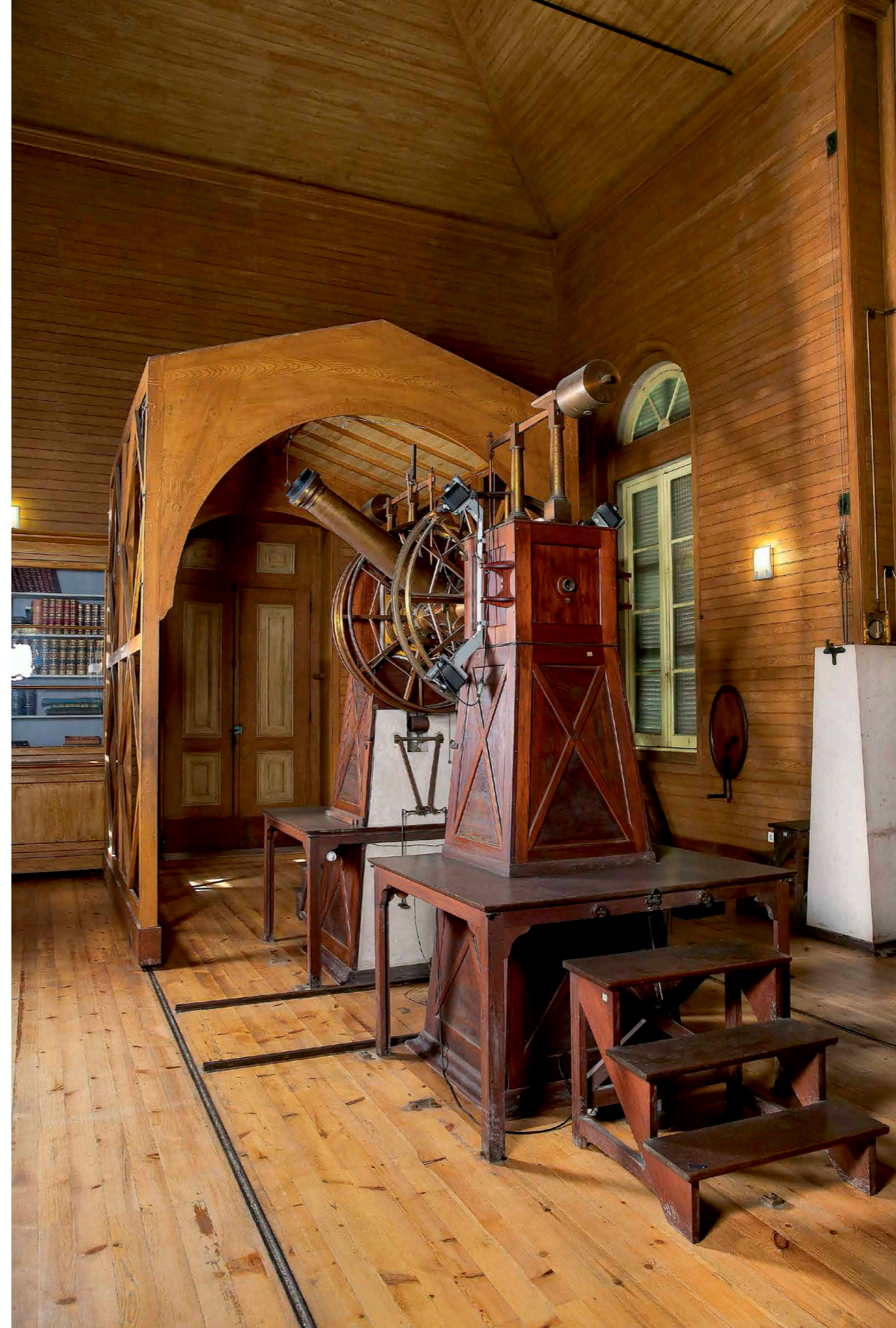
Círculo meridiano do Observatório Astronómico de Lisboa, instalado na sala de observações poente. Este instrumento era usado para medir, com grande rigor, a declinação (ou distância angular em relação ao pólo celeste) dos astros, bem como a latitude do lugar. É constituído por um grande círculo graduado ligado a uma luneta, ambos orientados no plano do meridiano (norte-sul).
